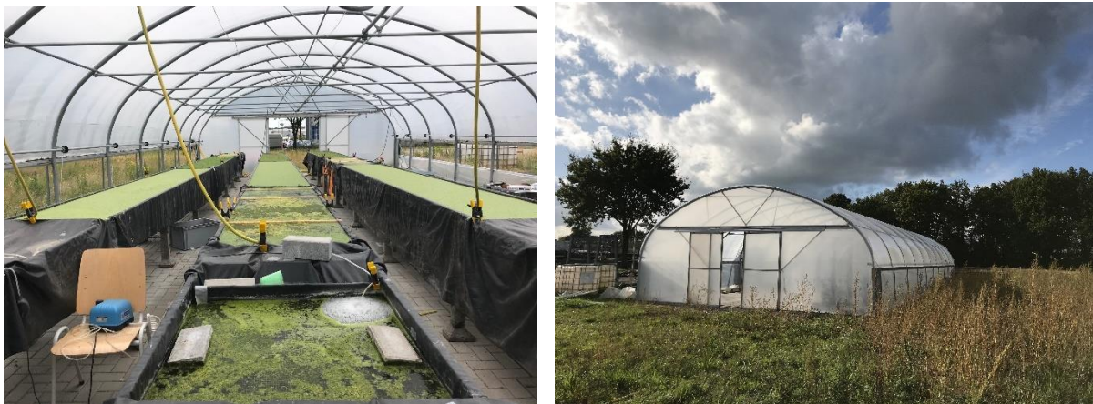
Figuur 2: De opzet van de praktijkproef met een cascade van drie verschillende plantensoorten op het effluent van de RWZI Rhenen.
